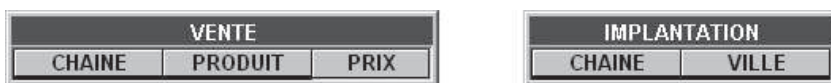
Figure 5.7 - Deux tables logiquement corrélées via les colonnes CHAINE , mais sans clés étrangères
